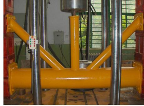
Fig. 2. Experimental test for KT-joint<sup>[6]</sup>
