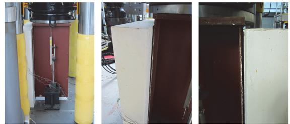
Fig. 8. Failure mode (Specimen EA-30-20-200)
