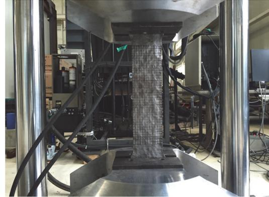
Fig. 5. Fatigue test setup
