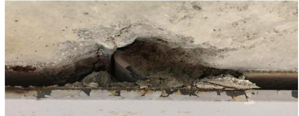
Fig. 11. Failure mode of stud
