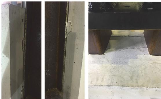
Fig. 7. Failure mode (AN-160-60-4.5)
