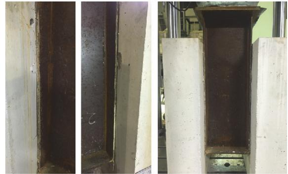
Fig. 9. Failure mode (AN-160-80-4.5)
