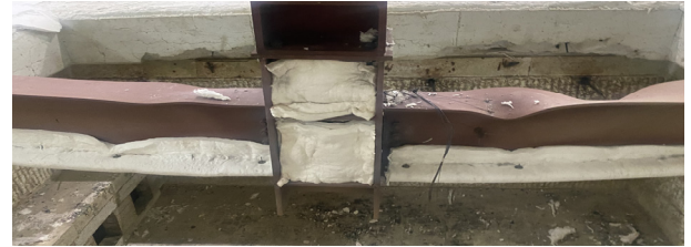
Fig. 19. Web-plate specimen after fire test
